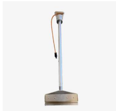
Abbildung 1: Heiss Schneidegerät für den Rückbau HBCDD-haltiger Fassadendämmungen. Quelle: EcoHeatDynamics
